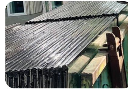
페어 코레실 SL921(FC)는 중성 경화형의 1액형 속건 타입 실리콘 실란트로서, 내후성 및 내구성이 우수하며, 복층유리 제작용으로 개발된 제품입니다.
